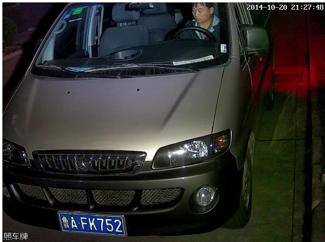
图 4：图为摄像机高度 2 米，摄像机距离车子 2 米。
