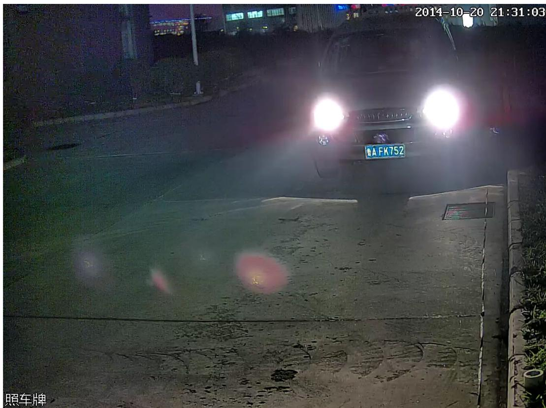
图 8：车子开启远光，距离车牌 10 米。
