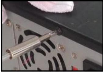
2. 拧开硬盘支架上的螺丝，并取下硬盘支架。
