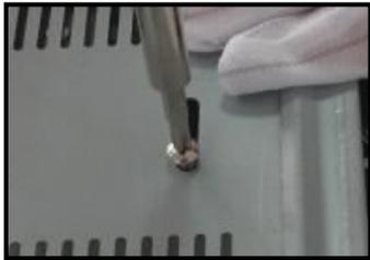
4. 当固定好硬盘后，将组装好的硬盘及其支架一起放置在NVR的机箱内，并用螺丝固定。
