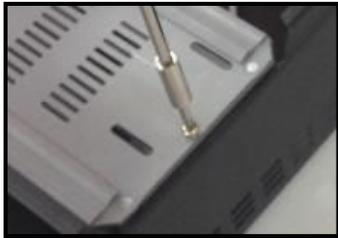
3. 将硬盘用螺丝固定在硬盘支架上，若安装多个硬盘时，可依次固定好。
