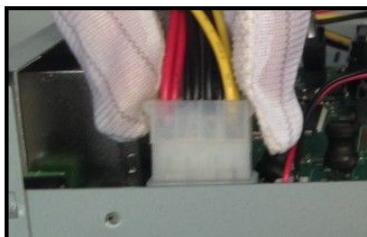
4. 将硬盘数据线、电源线另一端连接在硬盘上。
