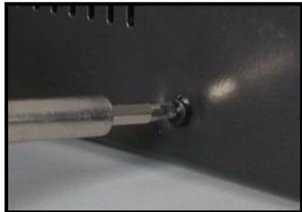
2. 将硬盘上的螺丝孔与机箱底板上的螺丝口对齐，并逐个拧上固定硬盘的螺丝。
