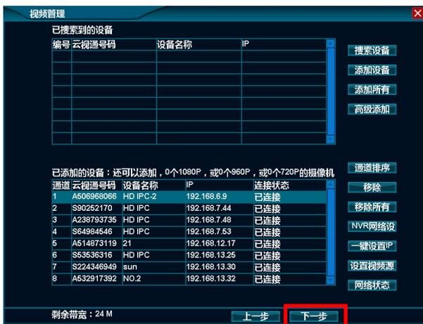
5. 设置五：可对录像码流与互联网码流进行设置等操作，其图如下所示，待设置完成后鼠标单击“下一步”按钮；
