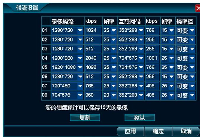
3. 更改如上图所示的“码流设置”界面中任意通道的码流大小，即可完成码流设置操作。
