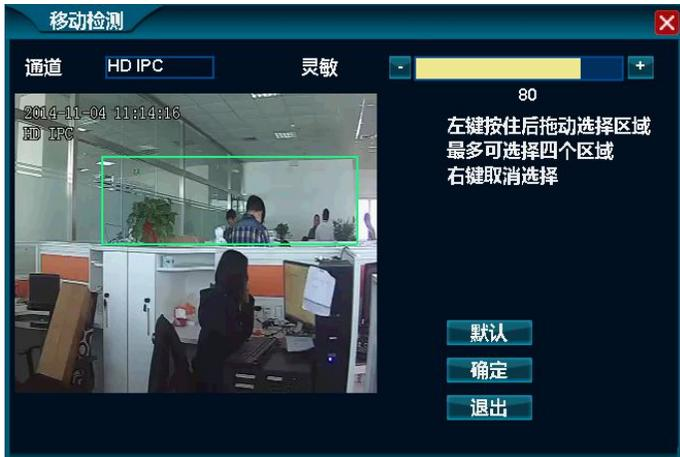
注：1. 设置区域后仅检测区域内部的移动物体，区域之外不检测，如上图只检测绿色框内的移动物体。
