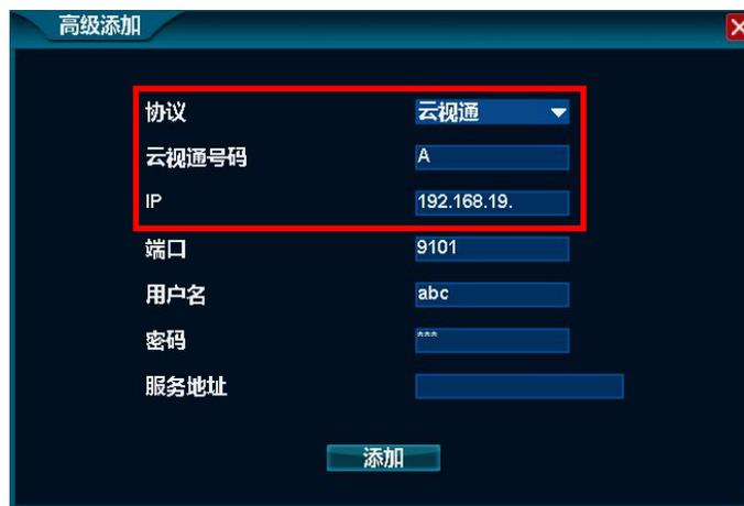
2. 在如上图所示的界面中，选择添加该设备的协议、输入云视通号码或IP地址等信息后，鼠标单击“添加”按钮，即可完成添加该设备的操作，其图如下所示：
