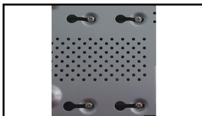
4. 盖好机箱上盖板，并将盖板用螺丝固定。
