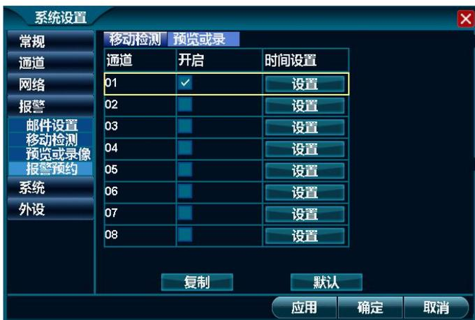
3. 鼠标单击任意通道对应的“时间设置/设置”按钮，则系统打开报警预约开始和结束时间的设置界面，其图如下所示，待设置完成单击“确定”按钮即可完成移动检测的报警时间预约设置操作。
