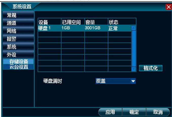
3. 鼠标单击选中任意一个存储设备的信息，并单击“格式化”按钮，则可打开确认要进行格式化的界面，其图如下所示，单击“确定”按钮，即可开始格式化所选的硬盘；
