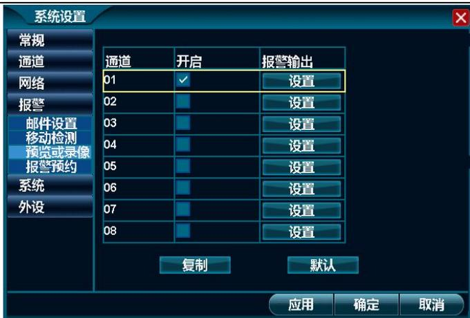
3. 鼠标单击任意通道的“报警输出|设置”按钮，则可打开该通道的报警输出界面，其图如下所示，待设置完成并单击“确定”按钮，即可完成视频丢失的报警设置操作。
