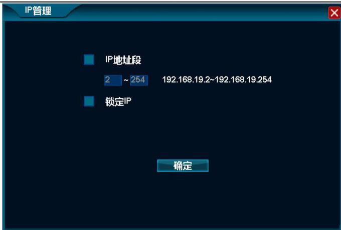
2. 鼠标单击选中如上图所示界面中的“IP地址段”复选框按钮，手动输入IP地址的范围值，并单击“确定”按钮，即可完成一键设置IP的操作。
