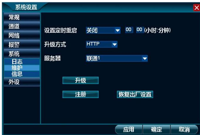
2. 鼠标单击如上图所示界面中“升级方式”下拉列表框按钮选择“FTP”方式，并输入正确的FTP地址后，鼠标单击“升级”按钮，其图如下所示，即可完成FTP升级操作。
