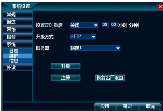
2. 鼠标单击如上图所示界面中“升级方式”下拉列表框按钮选择“USB”方式后，鼠标单击“升级”按钮，其图如下所示，即可完成USB升级操作。
