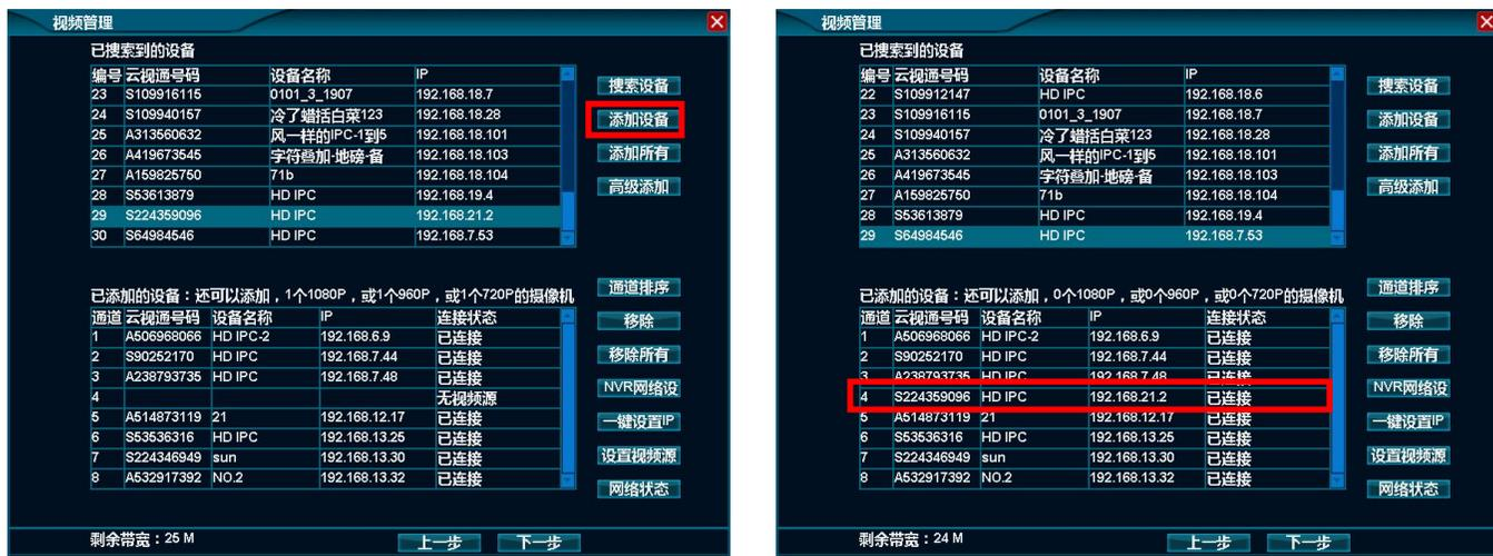
注：鼠标单击“添加所有”按钮可实现一键添加所有IPC设备的操作，但不能超过本机的最大编解码能力。
