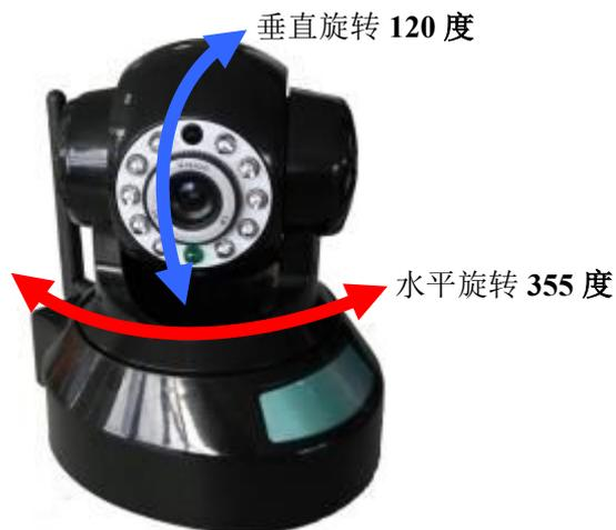
**第三步：**连接本机的电源线；网线接口 RJ45 连接到路由器或交换机上；并接入音频输出设备（如，耳麦）即可完成其安装过程。
