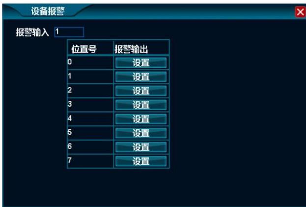
6. 鼠标单击输入报警设备对应位置号的“报警输出|设置”按钮，则可打开输入报警设备对应的输出报警设备的报警输出设置界面，其图如下所示，待设置完成并单击“确定”按钮，即可完成设备报警的设置操作。
