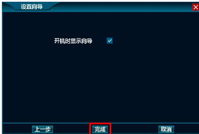
注：需要选中“系统设置|常规|常规|开机时显示向导”复选框按钮后，每次开机时才会显示开机向导功能。
