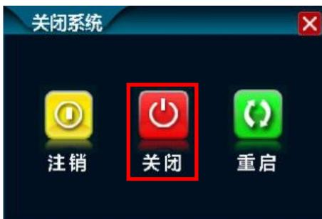
2. 鼠标单击如上图所示界面中的“关闭”按钮，则系统可自动关机。
