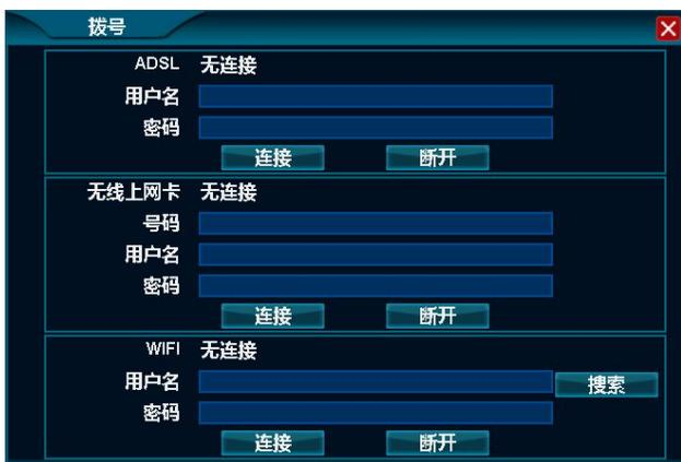
2. 在打开的拨号界面中输入 ADSL 拨号的用户名、密码后，鼠标单击“连接”按钮，则可进行拨号连接，待拨号成功后系统会打开提示界面。
