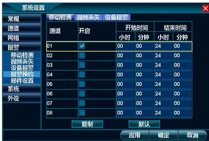
3. 鼠标单击任意通道对应的“开始时间/结束时间”，并设置其具体的报警预约开始和结束时间，待设置完成单击“确定”按钮即可完成移动检测、视频丢失及设备报警的报警时间预约设置操作。
